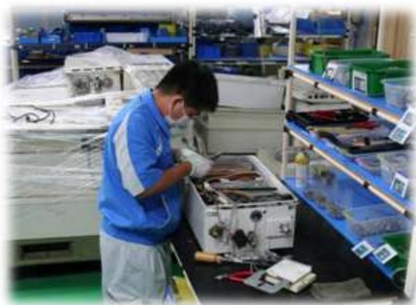
エアドライバーを装備した給湯機の分解設備
