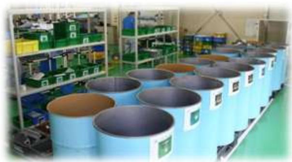
各部品ブロックは専用の作業台で分解します。細かく分解された部品は、材質別に準備されたドラム缶や棚上に置かれたケースに分別していきます。いかに確実に分別されているかが、一番重要なポイントになります。
